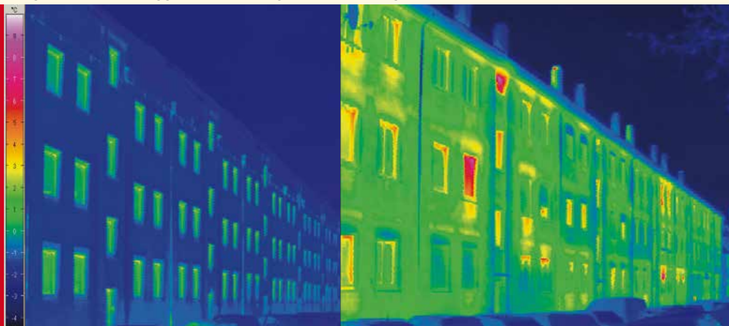
Thermografieaufnahme eines Sanierungsgebäudes nach der Sanierung (links) und vor der Sanierung (rechts)
